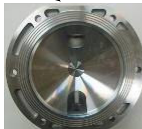
写真1 ダイアフラムポンプ内の仕上げ状態
