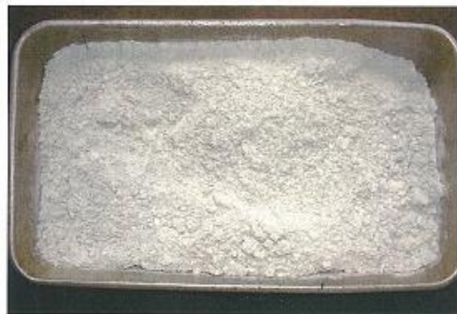
写真2 (Test-1) 乾燥品外観 排出量：5.3kg (計算値=5.2kg)
