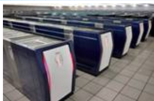
地球シミュレータ 超高速並列型スーパーコンピュータ 平成21年3月に新たなシステムに更新し 理論演算速度が従来の3倍となった
