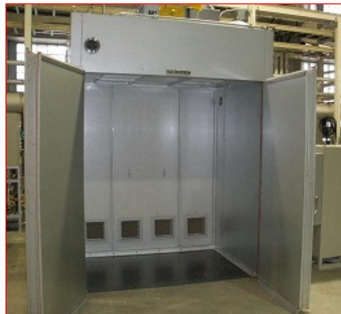
**小型脱臭炉廃熱利用バッチ式乾燥炉 (5m<sup>3</sup>)**
