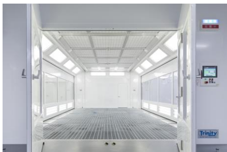
塗装プラント（塗装ブース）
