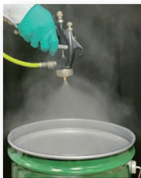
エアスプレーによる大量飛散
