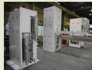
工場エアーにより風を起こすエアブロー装置は風速30m/sec以上、また自前のファンを使用しスリットノズルで風を起こすターボブロー装置は風速60m/sec以上を確保できます。除塵または水切りとして活躍しています。
