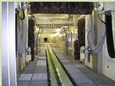
塗装前の除塵装置として活躍しているワイプ装置は、当社がパイオニアであり、いまや車メーカー各社の塗装工程で欠かせない装置となっております。近年はロボットツールとしても進化しています。
